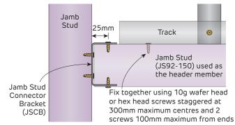
**FIGURE 16b Header to Jamb Stud Connection**With Jamb Stud Connector Bracket
