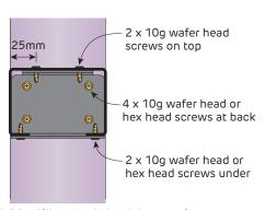
FIGURE 20a Sill to Jamb Stud Connection With Jamb Stud Connector Bracket Section
