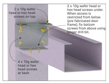
FIGURE 17 Jamb Stud Connector Bracket
