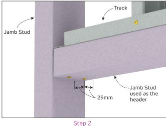
FIGURE 15 Header to Jamb Stud Connection
