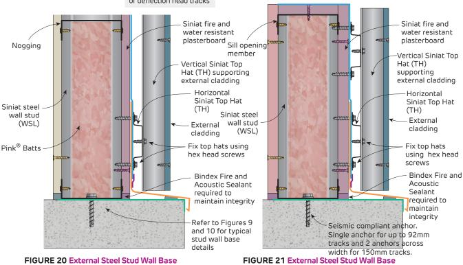
FIGURE 20 External Steel Stud Wall Base
