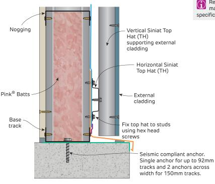
FIGURE 17 External Steel Stud Wall Base
