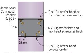
**FIGURE 16a Header to Jamb Stud Connection**With Jamb Stud Connector Bracket
