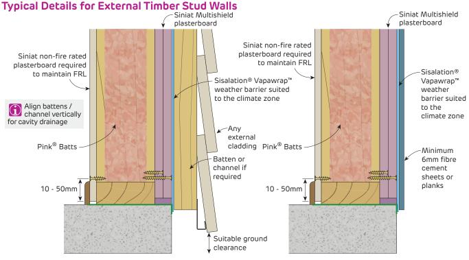
FIGURE 4 External Timber Stud Wall Base
