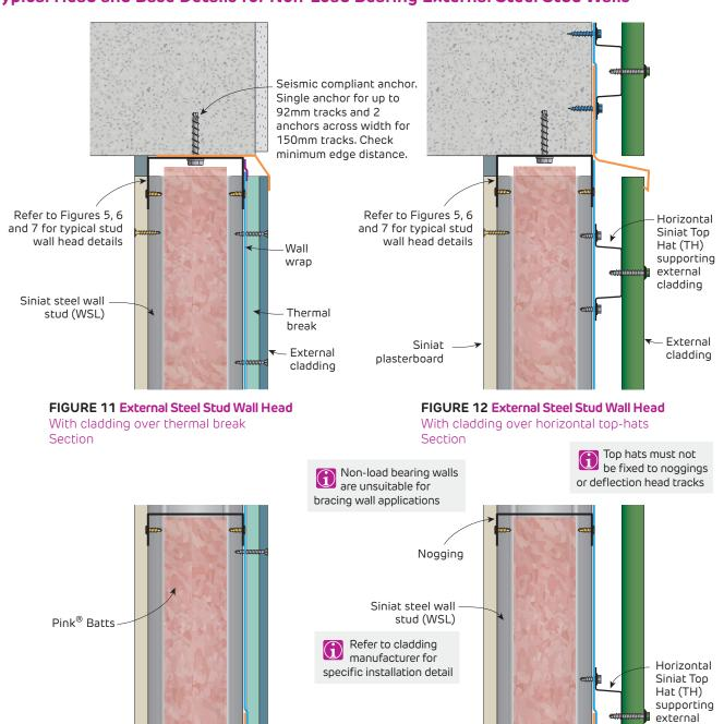
FIGURE 13 External Steel Stud Wall Base
